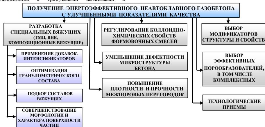
Рисунок 1. Алгоритм получения энергоэффективного газобетона с улучшенными показателями качества
