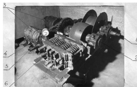
Рисунок 1. Экспериментальная установка пресс-валкового измельчителя
